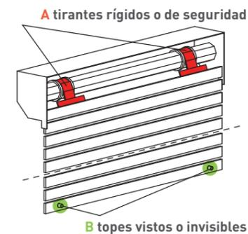
La instalación es muy fácil: tras haberlos instalado en la persiana, ésta se regula automáticamente. A tal fin son necesarios los accesorios indicados en los puntos A y B.
